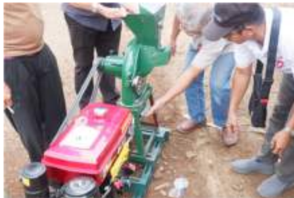
Gambar 4. Uji coba alat penggiling teh
