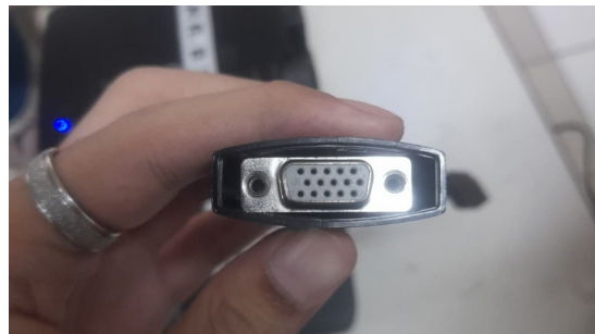
Gambar 2. Kondisi Fisik Konektor Kabel yang Rusak dan Tidak Stabil
