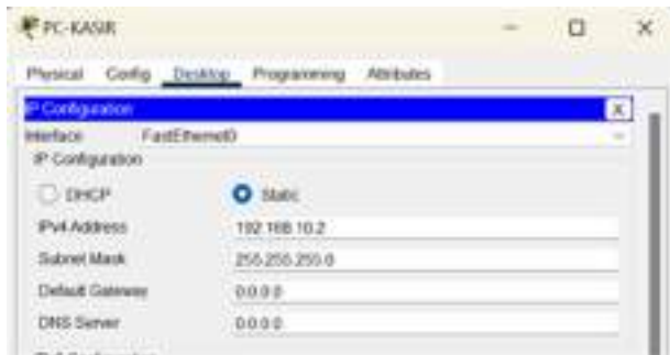
Gambar 10. Pemasangan IP Pada Komputer Kasir Lantai 1
