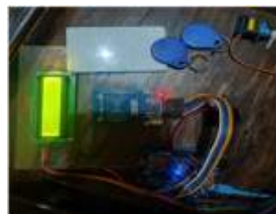
Gambar 8. Rangkaian Pengontrol Brankas
