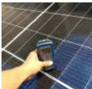
Gambar 7. Pengukuran Intensitas Radiasi Matahari
