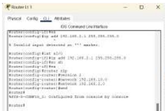
Gambar 6. Konfigurasi Router Lantai 1
