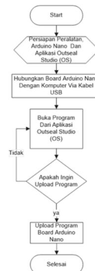
Gambar 10. Diagram Alir Proses Pemrograman Arduino Nano
