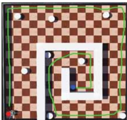
Gambar 7. Jalur Robot E-puck pada Arena 1 dengan Metode PID
