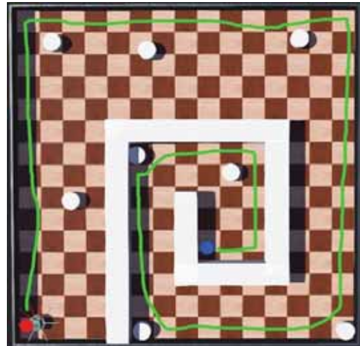
Gambar 8. Jalur Robot E-puck pada Arena 1 dengan Metode Fuzzy
