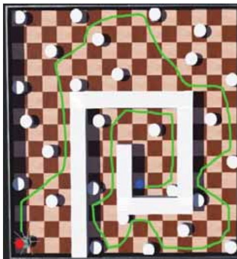
Gambar 10. Jalur Robot E-puck pada Arena 2 dengan Metode Fuzzy
