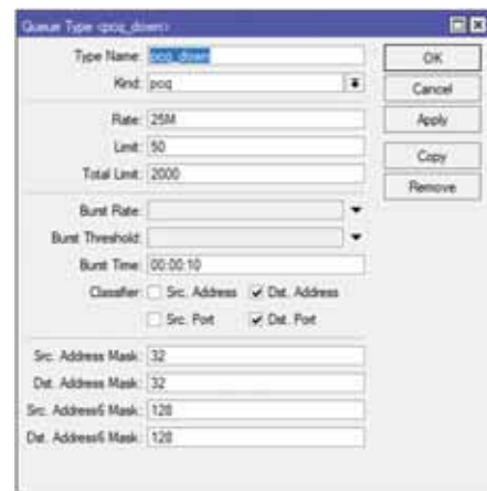
Gambar 10. Konfigurasi Tipe Queue PCQ Download
