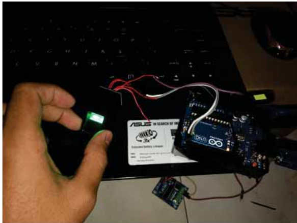
Gambar 7. Pengujian Sensor Sidik Jari
