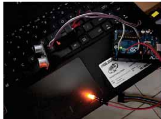
Gambar 8. Pengujian Sensor Gerakan
