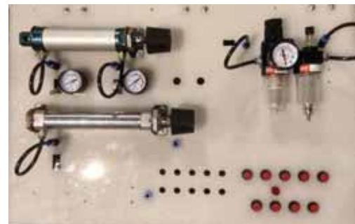
Gambar 4. Proses pemasangan komponen rangkaian elektro pneumatic system
