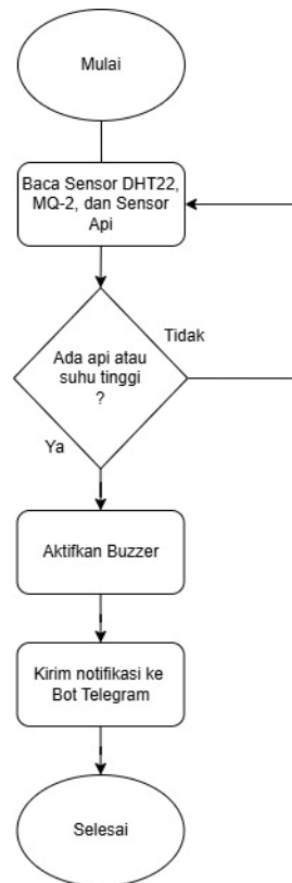
Gambar 2. Flowchart Purwarupa Sistem Peringatan Dini Kebakaran
